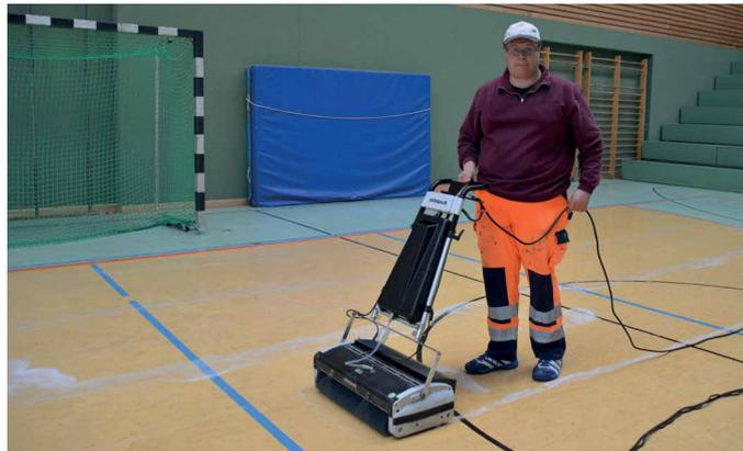
Das im Handballsport von Spielern verwendete spezielle Harz für eine bessere Ballhaftung wird durch Ball und Schuhe über den gesamten Hallenboden verteilt und festgetreten. Die Harzrückstände können durch den Einsatz des Rotowashmodells RW 60 P und durch das biologische Reinigungsmittel „Enz 7“ vollständig entfernt werden.
